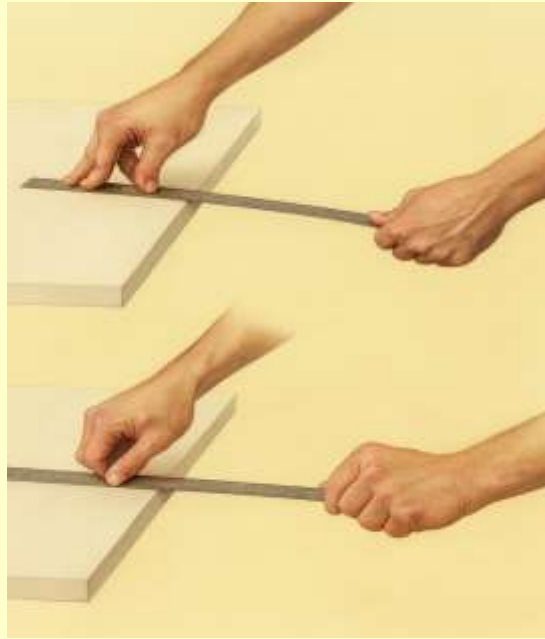
Şekil 1.19 Bir cetveli kenarından bükmeye çalışmak, düz kesitinden bükmeye çalışmaktan çok daha zordur. Raketlerde de durum aynıdır ve bu nedenle çerçeveler, topun çarpma kuvvetinin etki ettiği yönde daha geniştir.
